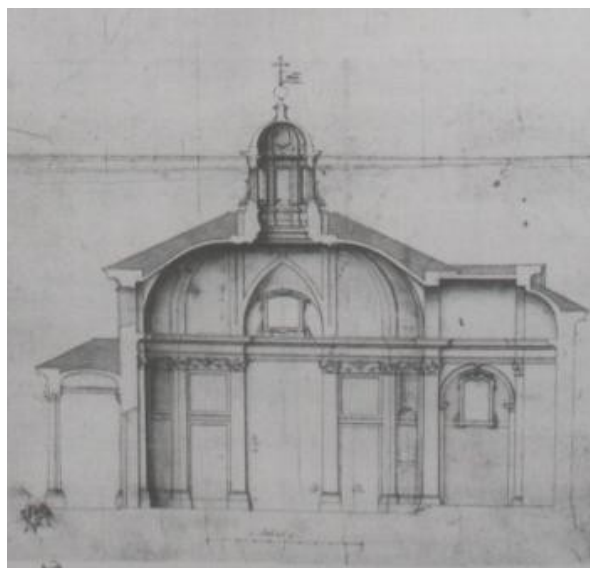
Obrázek 2.5: Použití jiné plochy pro zastřešení a jiné plochy pro klenbu stavby; originální plán F. Mangoneho (Bösel, R., Frommel, Ch. L. [2], obr. XXI.10).
