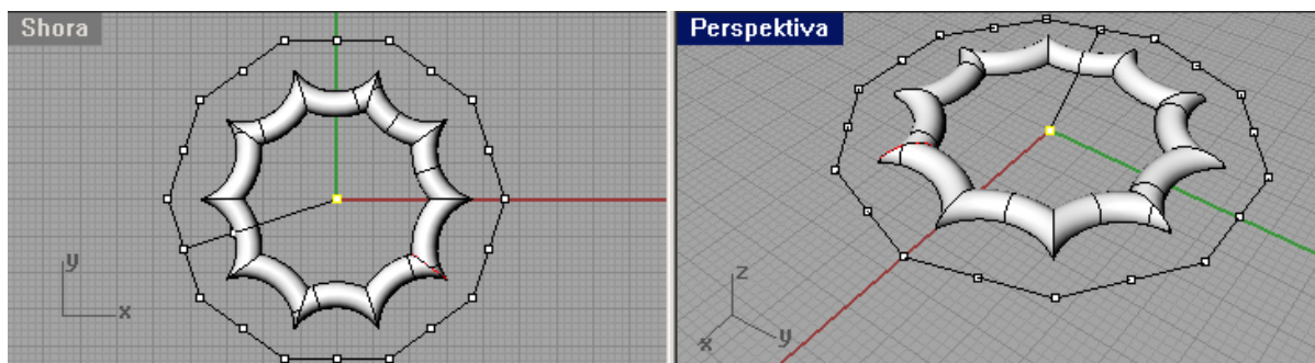
Obrázek 3.17: Rekonstrukce zaklenutí ambitu kostela sv. Jana Nepomuckého ve Žďáru nad Sázavou pomocí částí ploch anuloidů, červeně jedna z průnikových křivek dvou anuloidů.
